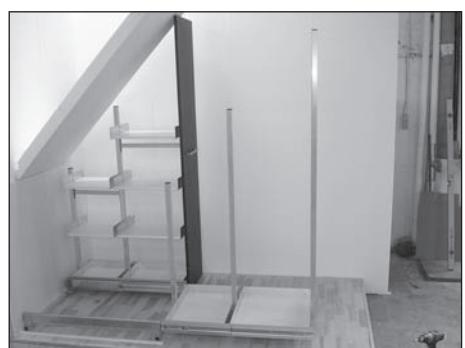
Den afskårne ende vendes nedad. Forreste og bageste rør fastgøres med 2 skruer C og midterste rør fastgøres med 4 skruer C.
