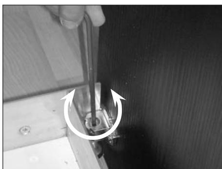
Skrueben i begge sider tilspændes for fast konstruktion.
