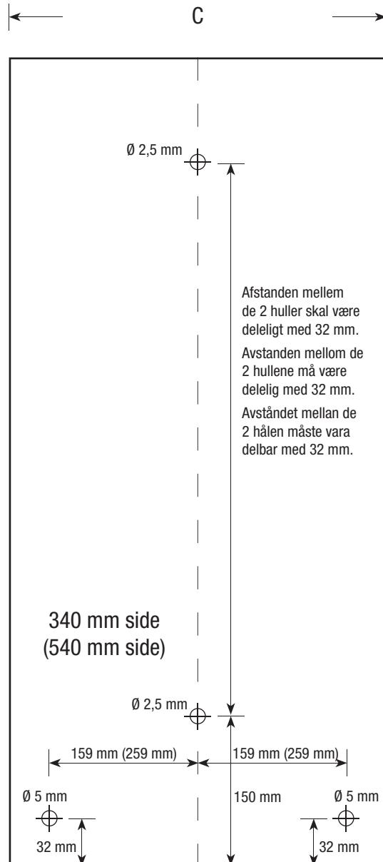
Forboring i låge til montering af skrueben og forboring i låge til montering på stolpe.
